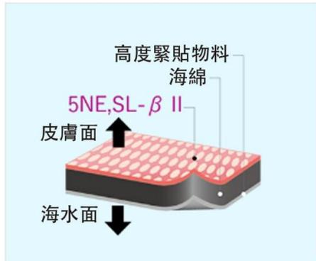
5HNE-SL-β II物料特性：5HNE-SL-β II物料兼具伸縮和保溫功能。這種布料是以特殊的低阻橡膠線編織而成，其CR發泡橡膠(海綿)的外層以微型纖維布料夾著，而皮膚面則以聚酯中空線(以低傳熱率的方法包含著空氣)製造而成，這樣的結構組合產生了伸縮性強、舒適無壓以及保暖良好的效果。穿著時，能使人稱身自在，感受良好。
