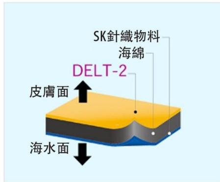
SK DELT-2物料特性：SK DELT-2 物料具有保溫性質，而且乾透的速度也很快。SK DELT-2物料的皮肤面是由絨毛布料與CR發泡橡膠(海綿)夾層製造而成。絨毛布料中的48%物料是由持水性低的聚酯中空線而成，能在身體和CR發泡橡膠之間形成了一個空氣層。這個空氣層在很大程度上有助於大大提高保暖的效果。另外，它還有助於把滲入的海水迅速排出，繼而發揮其良好的快乾特性。
